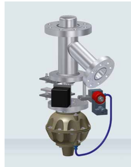
■ Typ BA / Type BA Kegelventil mit Membrantrieb, Endlagenschaltern, 3/2-Wegeventil und Verteilerbox Disc valve with diaphragm actuator, limit switches, 3/2 solenoid valve and junction box
